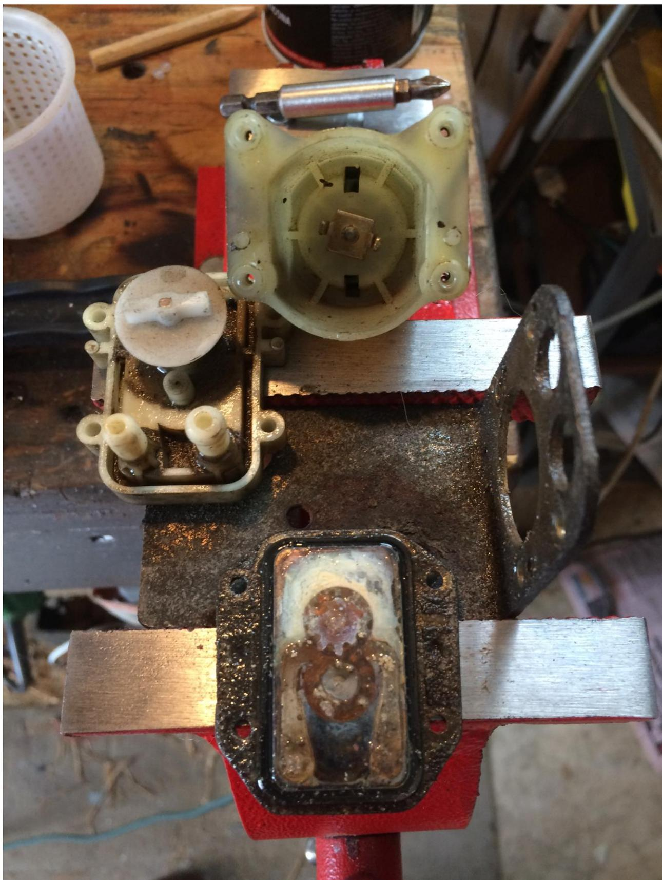
In quest'altra foto si nota (in basso) la parte inferiore del corpo girante, con le due ruote dentate, anch'esse bloccate dal calcare.
