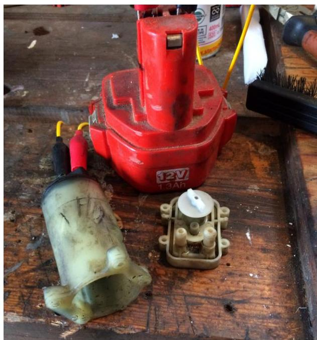
*In questa fase, se il motorino non dovesse girare, tentate questo espediente: invertite ripetutamente i poli, in modo da causare la rotazione in entrambi i versi. In questo modo, con alta probabilità di successo, dovrebbe sbloccarsi. Naturalmente se il motorino non dovesse partire... abbandonare il tentativo di riparazione ☹️*
