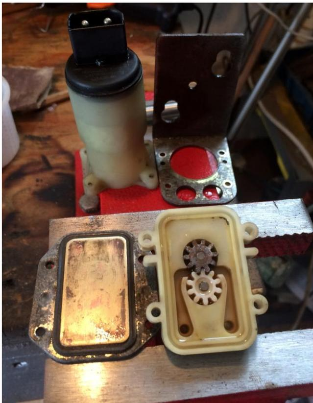
Una volta sicuri che la girante e le ruote dentate siano sbloccate e girino libere, lubrificare il gruppo girante con del silicone spray (o con un goccio di olio) da entrambi i lati.
