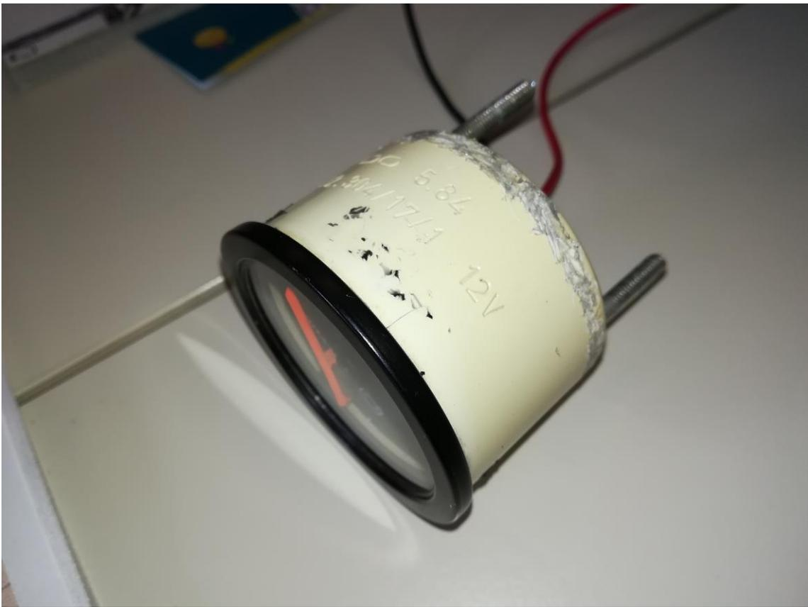
Per riattaccare il fondello, basta usare la punta di un saldatore per unire le plastiche lungo tutta la linea di divisione.
